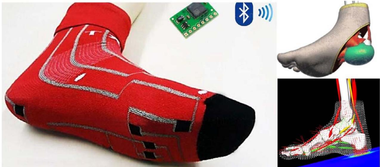
**Figure 4** : Gauche : mesure en continu des pressions d'interface via une chaussette ;
